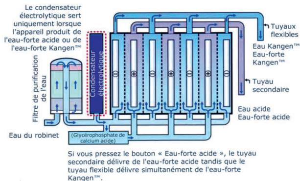
Le SD501, appareil au design compact et simple d'utilisation, est équipé de 7 plaques d'électrodes afin de garantir une puissance suffisante.
